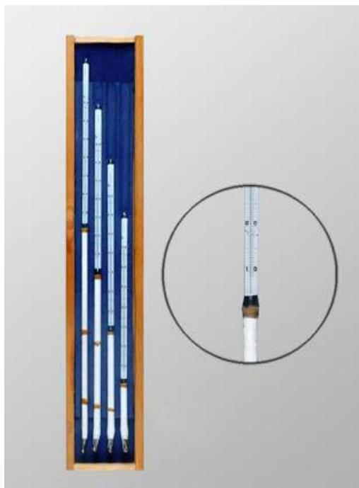
Принцип действия термометра основан на тепловом изменении объема термометрической жидкости, в зависимости от температуры измеряемой среды.
