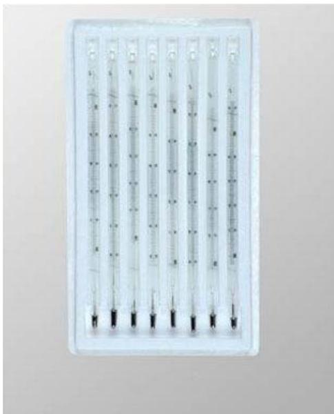
Принцип действия термометров основан на тепловом изменении объема термометрической жидкости, в зависимости от температуры измеряемой среды.
