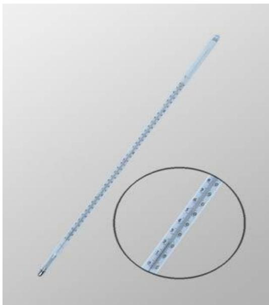
Принцип действия термометров стеклянных для испытания нефтепродуктов ТН-7 основан на тепловом изменении объема термометрической жидкости, в зависимости от температуры измеряемой среды.
