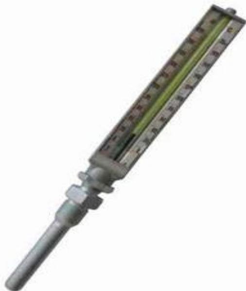
Принцип действия термометра основан на тепловом изменении объема термометрической жидкости, в зависимости от температуры измеряемой среды.
