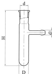
Пример обозначения: ПРОБИРКА С ОТВОДОМ 18-100
